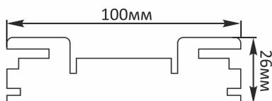
Схема сборки погонажа для системы пенал
