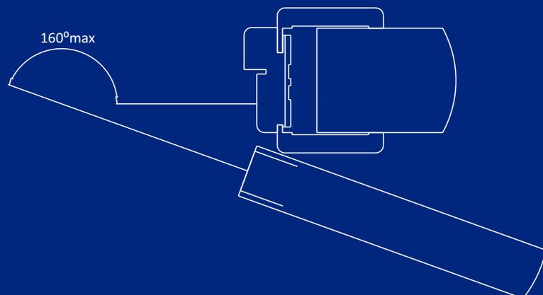
Врезка петли Anselmi 511 (коробка ТС компланар и наличник ТС компланар)
